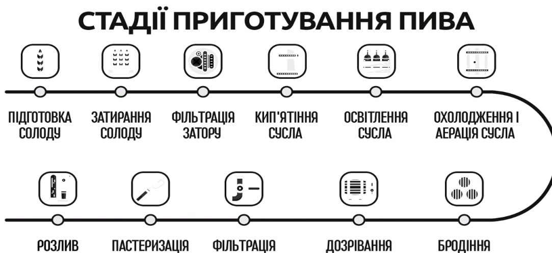
Рис. 5. Схема технологічного процесу виробництва світлого фільтрованого пастеризованого пива
